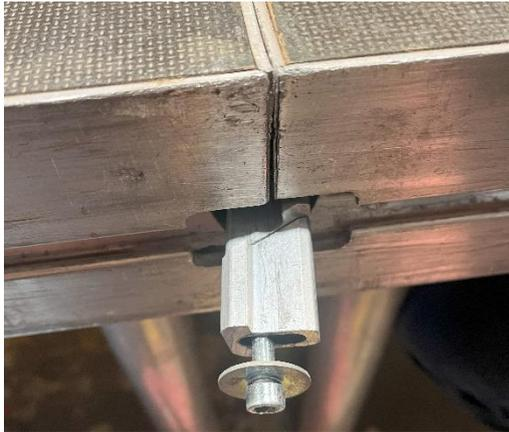
Insérer les sucres de plaquage horizontal entre chaque « intersections » et serrer la vis à l'aide de la clef Allen 6.
