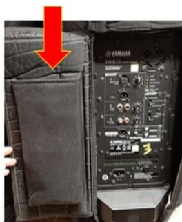
Pour une utilisation en extérieur il est possible de garder la housse de protection installée (imperméable **seulement en cas de pluie fine de courte durée**) : relever la face avant de la housse
